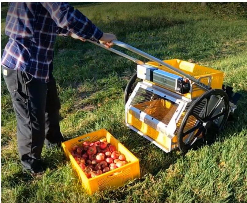
Figure 3. Récolte des pommes au sol à l'aide de la récolteuse électrique SilverFox Obstraupe de Organic Tools
