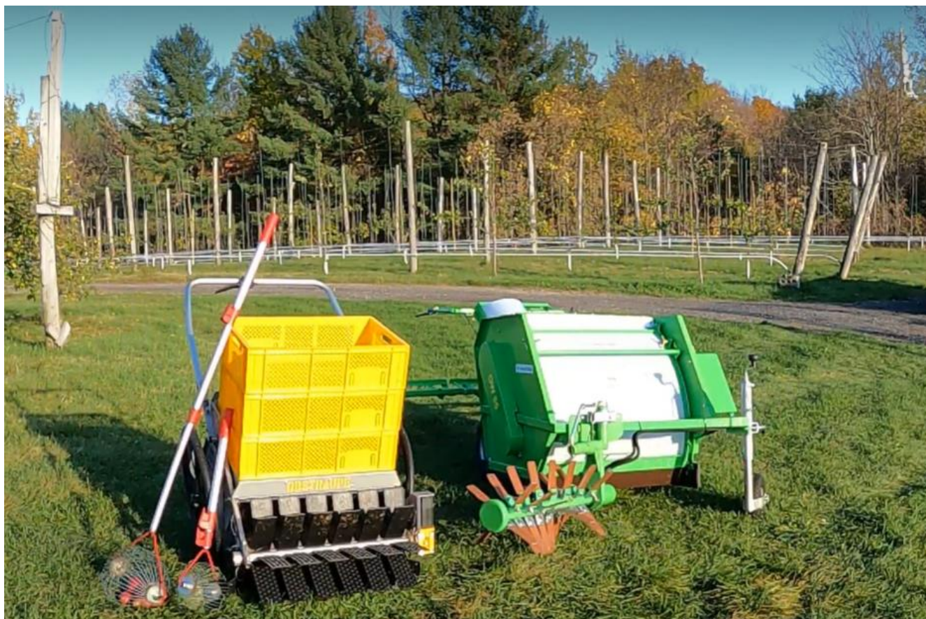
Figure 1. Outils de récolte des pommes au sol. De gauche à droite, dispositif de collecte Rollblitz de Feucht obsttechnik (présentés en 2 tailles), la récolteuse électrique SilverFox Obstraupe de Organic Tools et la récolteuse motorisée OW85 de Bäuerle obstwiesel.
