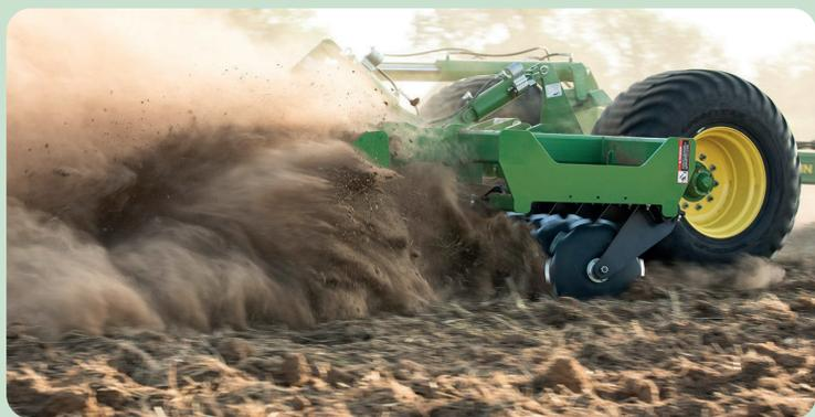
La vitesse d'avancement de l'équipement doit être élevée pour que l'effet de coupe et d'enfouissement des résidus par les disques soit efficace. Attention à une vitesse trop élevée qui pourrait créer de l'oscillation et un travail de sol irrégulier. Les vitesses recommandées varient entre 8 km/h et 15 km/h.
