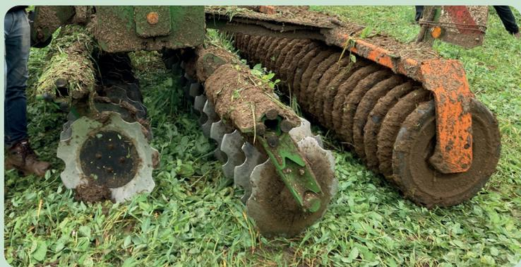
Les disques sont disposés sur deux axes, avec une orientation inversée. Il est crucial d'ajuster le niveau entre l'avant et l'arrière de l'équipement afin que les deux rangées de disques travaillent à la même profondeur. Sinon, l'équipement pourrait tracter latéralement.
