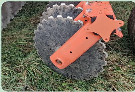
Les disques robustes sont larges et crénelés pour réduire le bourrage.
