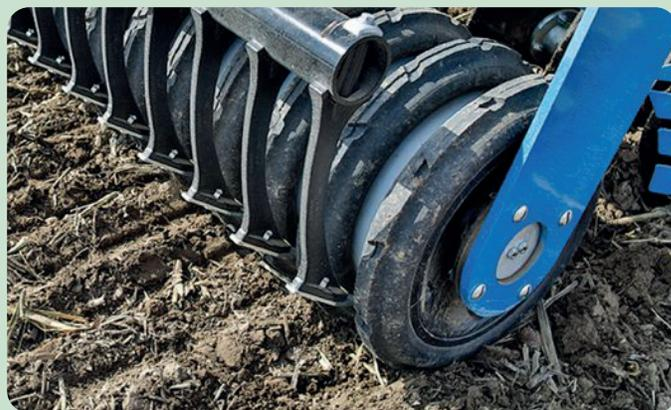
Le rouleau Packer est constitué d'une série de cerceaux parallèles en acier ou en caoutchouc. Il est plus lourd que le rouleau cage, mais il est plus efficace pour réappuyer le sol travaillé. Ce type de rouleau a plus de portance en sol léger qu'un rouleau cage simple.
