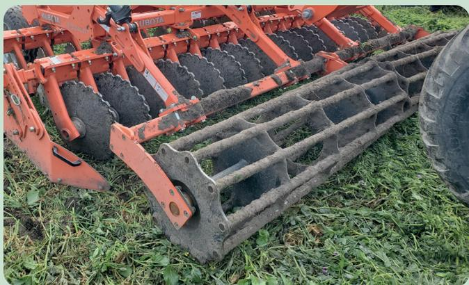
Le rouleau cage est léger. Il est souvent utilisé en tandem de tailles différentes pour optimiser l'émiettement, le nivelage et le réappuyage du sol travaillé.
