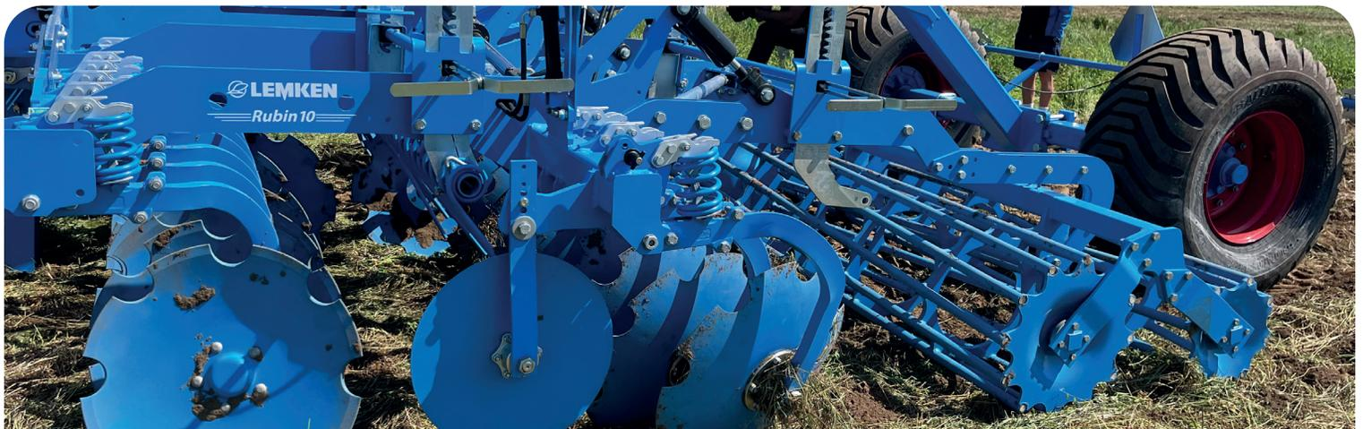
La déchaumeuse à disques est conçue pour couper et incorporer de la biomasse végétale dans les premiers 15 cm (6 pouces) du sol.
