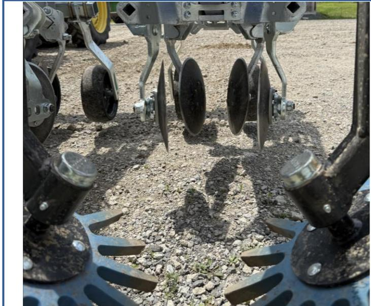
Cette configuration permet de travailler très près du rang, c'est-à-dire à 2 po de chaque côté du rang avec les disques avant. Ces disques coupent le sol sur une largeur de 3 po chacun. L'angle des disques arrière complète le travail des disques avant sur une largeur de travail de 2 po entre chaque disque.
