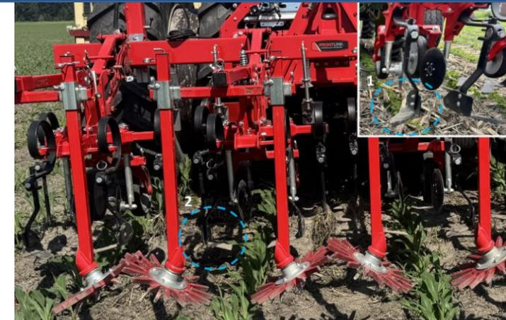
L'équipement qui a été sélectionné pour contrôler les graminées annuelles est une bineuse munie de disques concaves, de lames Lelièvre et de doigts sarcleurs. Les lames Lelièvre servent habituellement à couper les mauvaises herbes et projeter la terre dans l'entre-rang (1). Dans le cas présent, la position de celles-ci a été inversée sur les unités de la bineuse (2).
