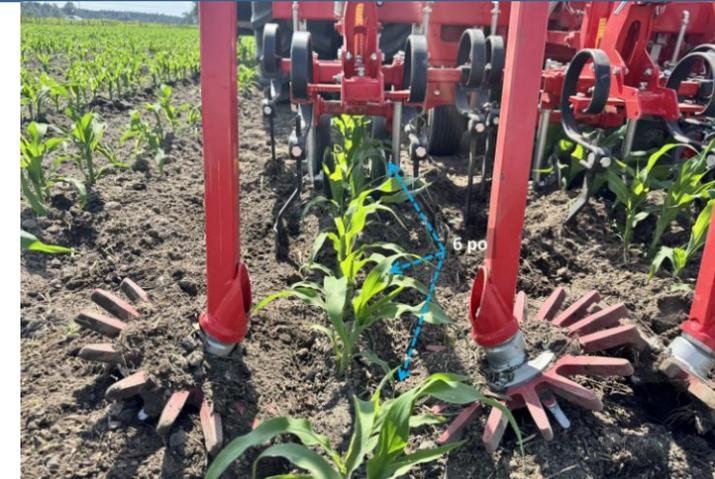
L'écartement entre les disques concaves est de 6 po à l'avant des disques. Ils ont été ajustés avec un angle et la largeur à l'arrière des disques est de 8 po. Les lames Lelièvre ont été positionnées à 3 po de part et d'autre du rang, ce qui permet de couper les mauvaises herbes près du rang et d'assurer une sécurité si le sarclleur dévie de sa trajectoire, et ce, même avec la présence d'un système de guidage par caméra. La vitesse d'avancement était de 7,5 km/h.
