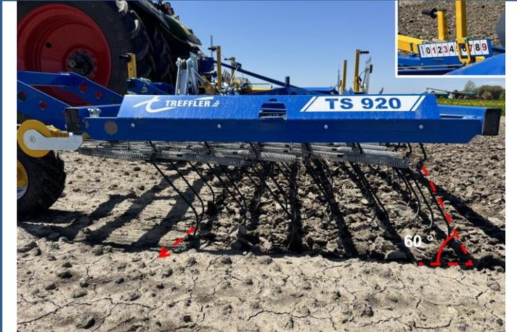
Dans ce cas, l'équipement qui a été utilisé a été une herse étrille à pression constante. Les dents ont été ajustées à la verticale avec un angle d'environ 60 degrés. Dans cette position, la partie inférieure de la dent est davantage vers le tracteur, ce qui aide les dents à pénétrer dans le sol. La pression de la herse étrille a été augmentée à 6 pour que la pointe des dents entre d'environ 1 po dans le sol.
