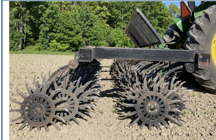
Une houe rotative peut être un équipement suffisant pour fracturer le sol et avoir un bon effet sur la répression des mauvaises herbes, surtout en condition de sol croûté.
