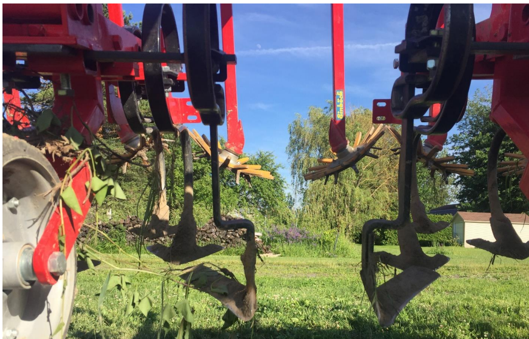
Figure 3. Lames Lelièvre au centre et pointes en forme de patte d'oie sur les cotés
