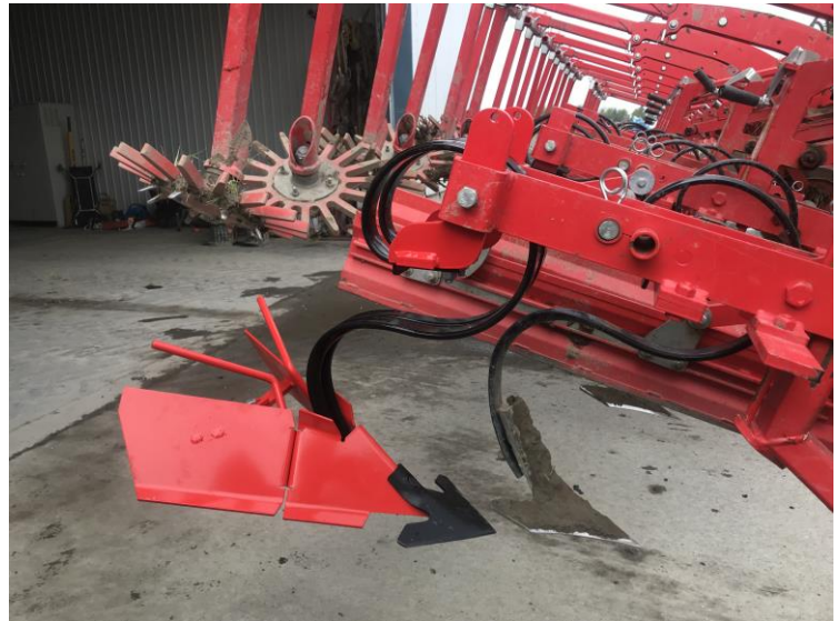
Aile butteuse de grande taille installée sur la dent arrière centrale
